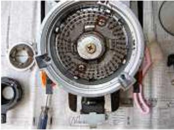
下刃の3方に3本の「バネ」が埋まっています、上刃と下刃の間隔を調整している。
